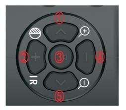
①数码变焦 + ; 在菜单模式下向上移动光标; 回放模 式下向上翻页。 ②长按切换黑白模式;黑白模式下短按增加红外强度; 回放模式下视频快退。
